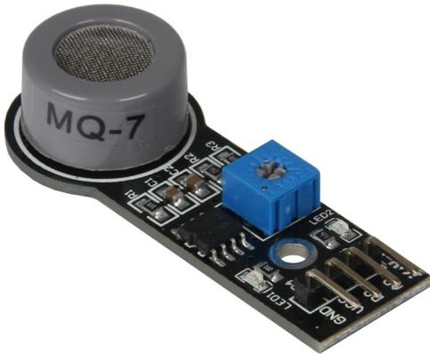
Dieser analoge Gassensor besitzt ein kleines Heizelement mit einem elektronisch-chemischen Sensor. Er ist für die Verwendung in Innenräumen geeignet. Er kann erst nach Beendigung der Aufwärmphase genaue Messwerte ausgeben.
