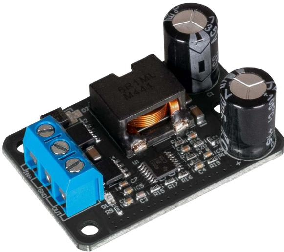
Dieses Spannungswandler Modul kann Eingangsspannungen von 9 - 35 V in eine Ausgangsspannung von 5 V herunter wandeln.
