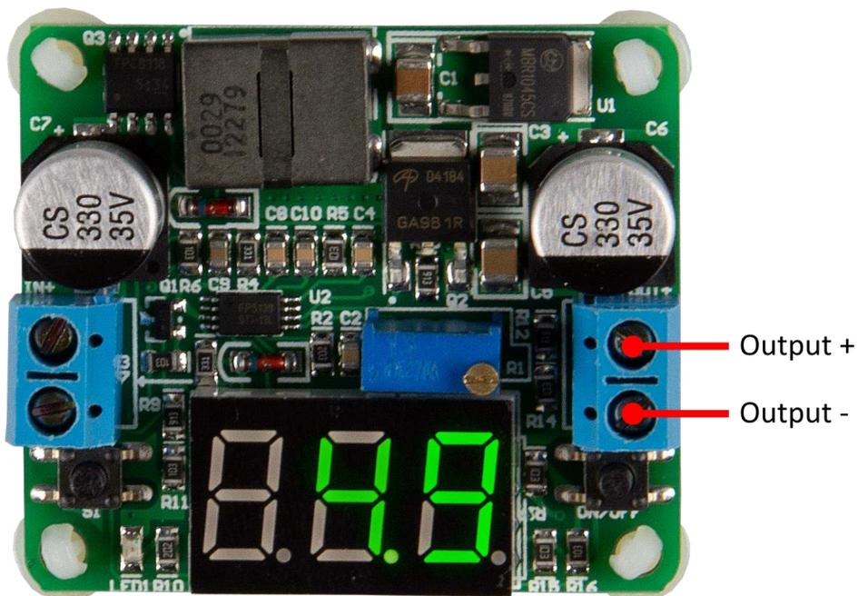
Mit der Einstellschraube lässt sich die gewünschte Spannung einstellen. Das Display zeigt hierbei die aktuelle Ausgangsspannung an.
