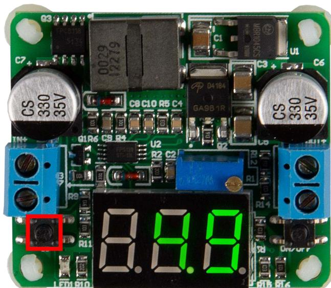
Mit der Taste **ON/OFF** kann der Spannungsausgang zusätzlich ein bzw. ausgeschaltet werden.
