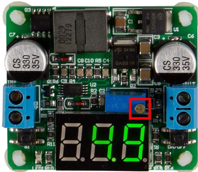
Mit dem Knopf **S1** können Sie durch insgesamt drei Display-Modi wechseln. Die Werkseinstellung zeigt nach dem Start des Gerätes automatisch den Eingangs-Modus. Hier wird die Eingangsspannung auf dem Display angezeigt. Die LED, welche sich direkt unterhalb des Knopfes befindet, leuchtet hierbei dauerhaft.
