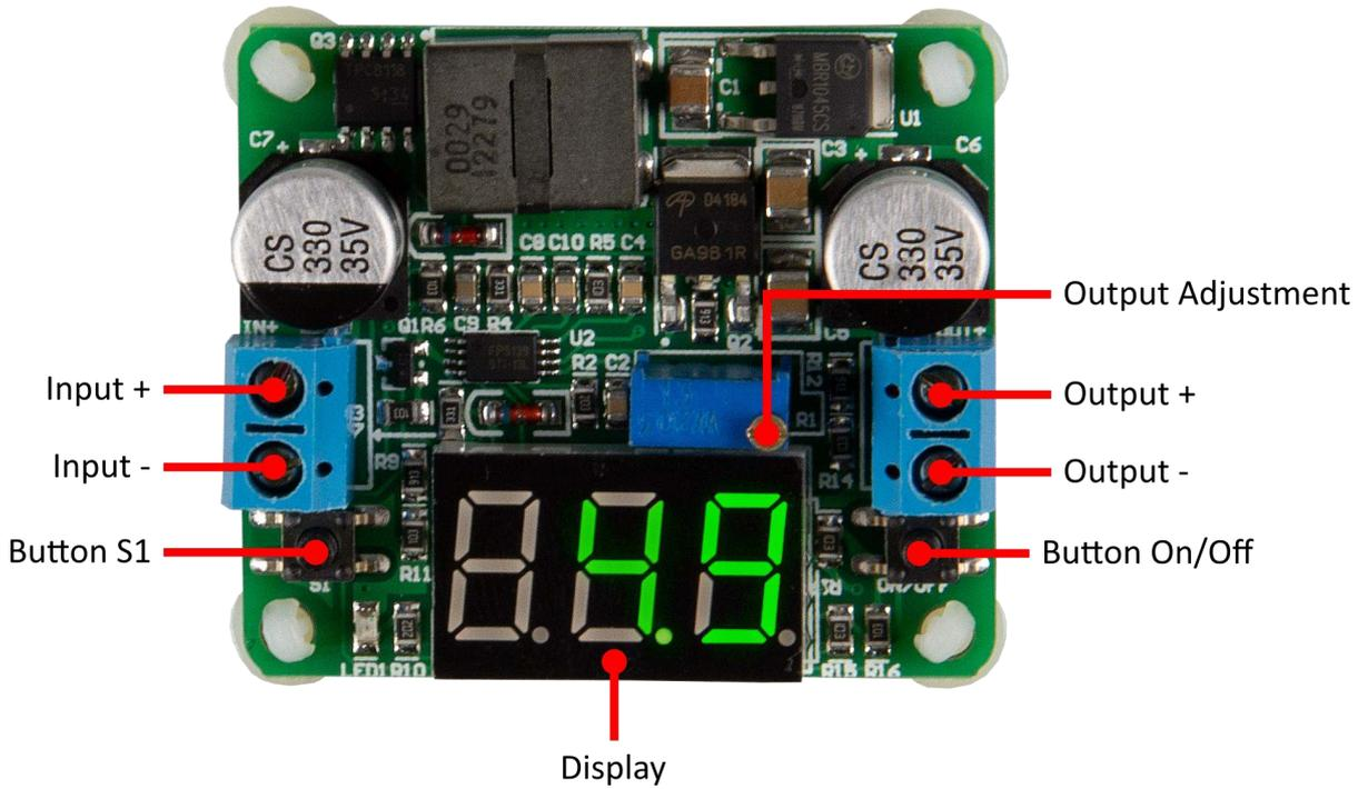
Das frei konfigurierbare Spannungswandlermodul ist mit einer "Step UP" und einer "Step DOWN" Funktion ausgestattet. Die Spannung ist mittels Trimmer individuell einstellbar und wird auf der integrierten Segmentanzeige wiedergegeben.
