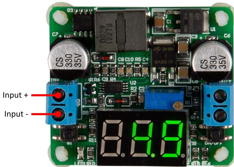
Schließen Sie als nächstes die Kabel des zu versorgenden Gerätes am Ausgang (**Output + / Output -**) an. Der Spannungswandler ist nun einsatzbereit.
