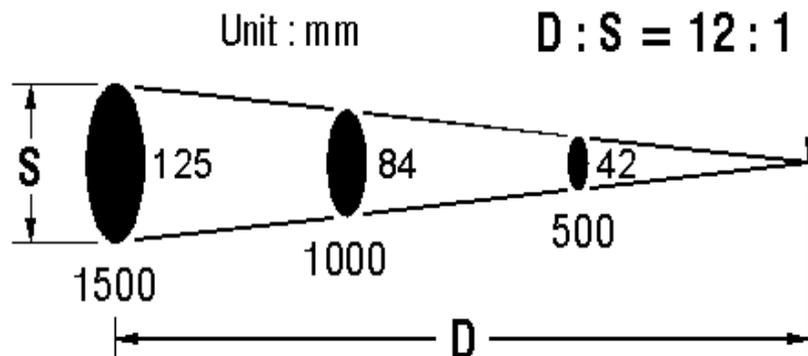
Während der Messung eines Objekts verwendet das Instrument einen indikativen Ring. Die Messtemperatur der Oberfläche ist die Innentemperatur dieses Rings.
