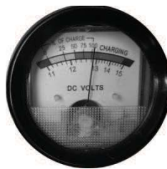
Figure 6 : La batterie est entièrement chargée
