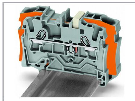
Reduzierbrücken schaffen den Übergang von querschnittsgroßen auf querschnittskleine Durchgangsklemmen, ohne Klemmstellenverlust. Sie sind z. B. interessant, wenn bei großen Leitungslängen der Spannungsfall gering gehalten werden soll, „vor Ort“ aber der Nennquerschnitt ausreicht.
