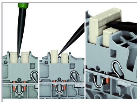
Das Kammbücker-System beruht auf dem Stecker-Buchse-Prinzip. Jede Klemme ist mit einer Doppelbuchse mit Fremdfederung durch eine Cr-Ni-Stahlfeder ausgestattet. Die Brücken selbst können deshalb aus Elektrolytkupfer besonders klein gefertigt werden. Dennoch sind sie bis zum Nennstrom der Klemme belastbar. Auch PE-Klemmen sind brückbar. Individuelle Brücken entstehen durch Herausbrechen von Kontaktstiften (Serien 2000, 2001, 2002, 2004).
