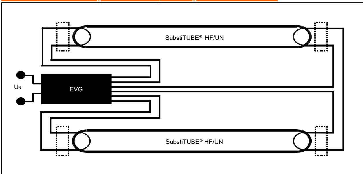
Auch bei mehrflammigen EVG-Leuchten wird die Verdrahtung nicht verändert. Die neu eingesetzte SubstiTUBE® HF/UN muss kompatibel mit dem installierten EVG sein.
