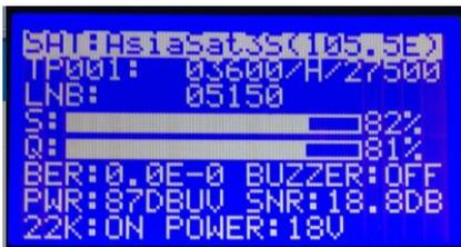
Das SFD11 startet mit dem Suchmenu wenn Sie die Spannungsversorgung anschliessen. Durch drücken der Taste **22K/ADD** kann das 22kHz Steuersignal An- und Ausgeschaltet werden. Taste **13V/18V DEL** um die Ausgangsspannung (Sat LOW/High Band) zu wählen. Mit der **ALARM** Taste kann des akustische Signal (Beeper) Ein- und Ausgeschaltet werden.
