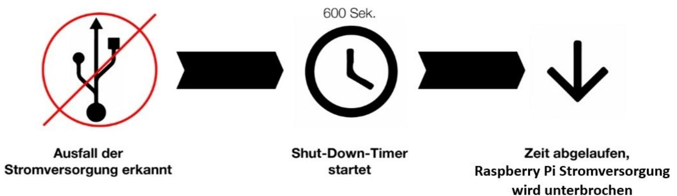
Wenn der StromPi3 nun einen Stromausfall erkennt, startet der Timer. Nach 10 Minuten trennt der StromPi3 dann die Stromversorgung zum RaspberryPi. Zusätzlich stellen wir ein Skript bereit welches entweder über die serielle Konsole oder über einen GPIO Pin einen Stromausfall erkennen kann und dann mit dem Sicheren herunterfahren des RaspberryPi beginnt.
