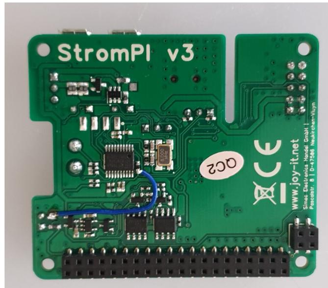
Zu Letzt wird das andere Kabelende an dem unteren Lötpad angelötet.
