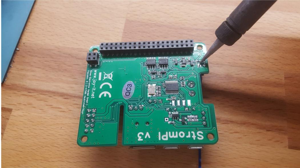
Das andere Ende des Kabels wird wie bei Variante 1 auf einen freien GPIO-Pin gesteckt.
