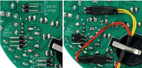
Der Zungentaster wird auf Z1 und Z2 gesteckt (Polung egal). Die Codierbrücke für die Spannungsversorgung, je nach Betriebsart auf "Vers.-Ext." oder "Int." bei B3, und die Spannungsversorgung unter Beachtung von + und - bei "Ext.Vers.". Der Kabelstrang kann mit einem Schrumpfschlauch zusammengefasst und unter die "+" Zunge des Batteriehalters geklemmt werden.
