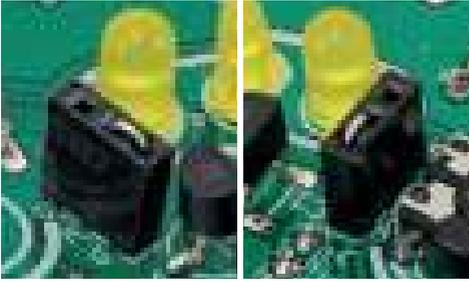
Anstelle der Drahtbrücken bei den Positionen B1 und B2 werden dreipolige Buchsenleisten montiert. Je nach gewünschter Funktion müssen die notwendigen Verbindungen über Drahtbrücken aus 0,5 bis 0,6 mm Schaltdraht mit einer Schenkellänge von 5 bis 6 mm ausgeführt werden, welche in die entsprechenden Kammern der Buchsenleiste zu stecken sind.
