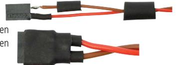
Beispiel für die Konvекtionierung von Verbindungsleitungen mittels Buchsenleisten und Schrumpfschläuchen
