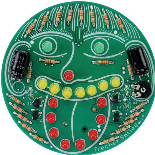
Bestückung für den Bausatz in seiner Grundausstattung: Die Brücke B1 wird von A nach D, die Brücke B2 von Z nach M und Brücke B3 von V nach I bestückt. Für die optionalen Ausbaustufen werden auf der Bestückungsseite die Brücken 1 und 2 durch 3-polige Buchsenleisten mit eingesteckter Drahtbrücke ausgeführt. Die Buchsenleisten sind jedoch nicht im Lieferumfang enthalten sondern müssen separat bestellt werden! Weitere Details: Siehe Punkt "Optionale Ausbaustufen"
