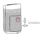
5. Drücke die in der Abbildung rot eingekreisten Tasten, um die Rückabdeckung zu schließen.
