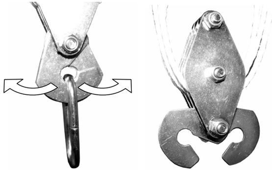
Um den Sicherheitsverschluss zu öffnen, ziehen Sie jeweils zwei Verschlusslamellen wie abgebildet jeweils in Pfeilrichtung nach links und rechts. Nach dem Einsetzen des Zughakens/Zugringes verschließen Sie den Sicherheitsverschluss wieder, die Last ist somit optimal gesichert.
