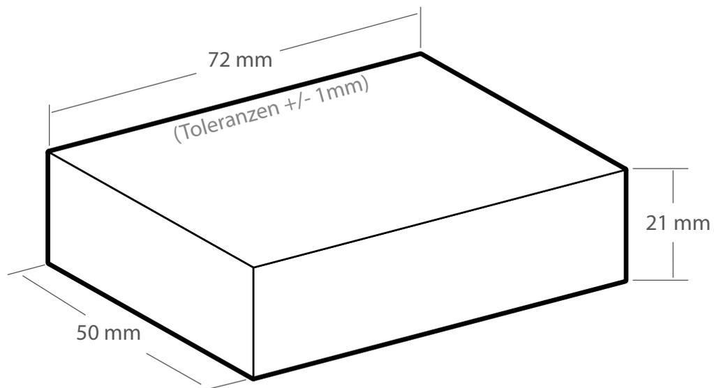
Gehäuseunterteil und Oberteil schwarz mit innenliegenden Befestigungsmöglichkeiten für Platinen.
