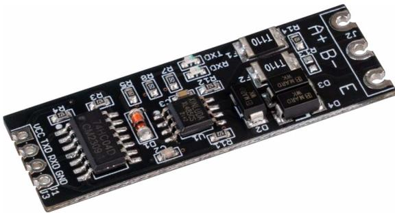
Dieser UART TTL zu RS485 Konverter ermöglicht Ihnen Ihren Singleboard-computer, um eine RS485 Schnittstelle zu erweitern.
