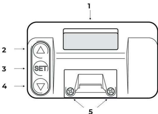
1. **Rückseitiges Display:** Zeigt die aktuelle Uhrzeit, das eingestellte Land, einen niedrigen Batteriestand und mehr an.
