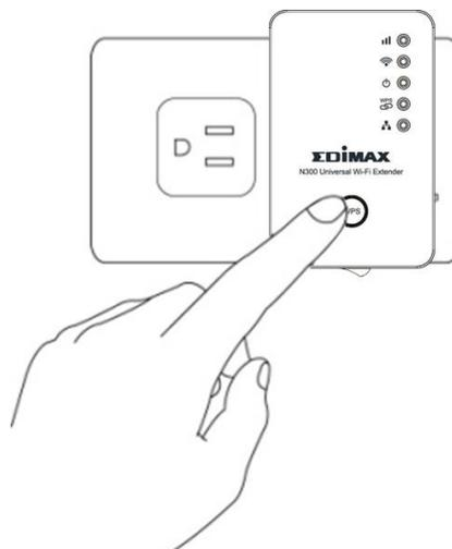
3. Drücken Sie innerhalb von 2 Minuten die WPS-Taste am Wurzel-WLAN-Access Point. Die Zeit, während der die Taste gedrückt werden sollte, hängt vom Router ab. Einige sprechen bei einem kurzem Druck an, während andere 2 oder mehr Sekunden brauchen.
