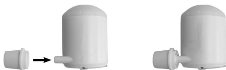
Fig. 2: Adapter aan pompuitlaat bevestigen
