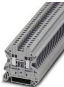
Durchgangsklemme, Nennspannung: 1000 V, Nennstrom: 24 A, Anschlussart: Schraubanschluss, Anzahl der Anschlüsse: 2, Querschnitt: 0,14 mm<sup>2</sup> - 4 mm<sup>2</sup>, AWG: 26 - 12, Breite: 5,2 mm, Höhe: 46,9 mm, Farbe: grau, Montageart: NS 35/7,5, NS 35/15
