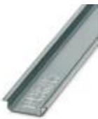
Tragschiene ungelocht, Standardprofil, Breite: 35 mm, Höhe: 7,5 mm, nach EN 60715, Material: Stahl, verzinkt, weißpassiviert, Länge: 2000 mm, Farbe: silberfarben
