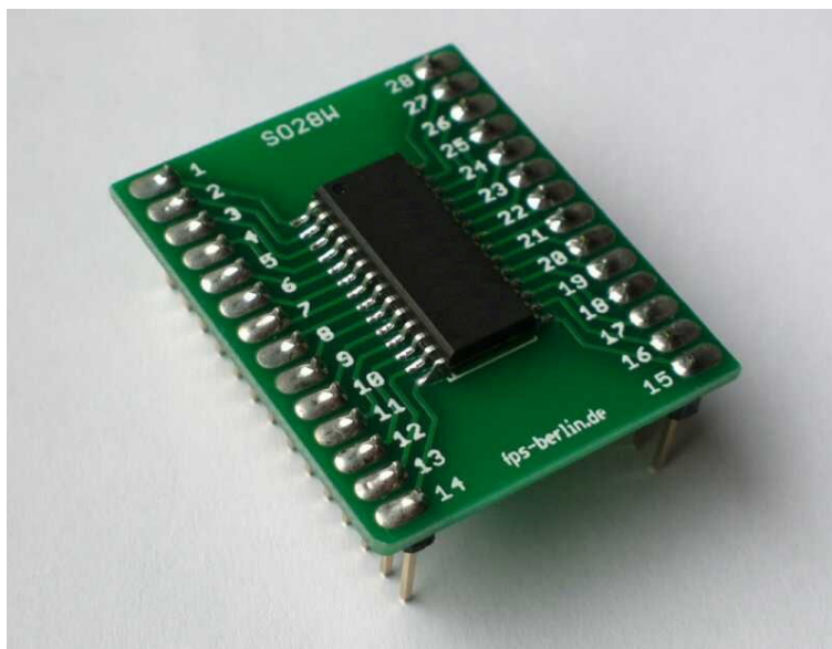
Anwendungsbeispiel Adapterplatine SO28W - SO28X
