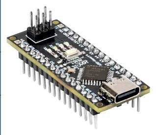
Der NanoV4-MC ist ein besonders kleiner Mikrocontroller und durch die nach unten herausgeführte Stiftleiste, speziell für die Arbeit mit Steckboards entwickelt.
