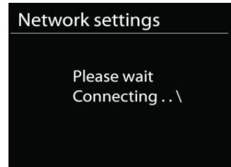
Ak je nastavenie úspešné, zobrazí sa ako pripojená. Ak pripojenie zlyhá, zariadenie ICD4350 prejde späť na predchádzajúcu obrazovku, aby sa pokus uskutočnil znova.
