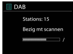
Kies Volledige scan om een scan uit te voeren. Zodra de scan voltooid is, toont de radio een lijst met beschikbare zenders.
