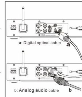
Utilizzare un cavo audio RCA o un cavo ottico per collegare le uscite del lettore DVD o del televisore all'ingresso AUX/OTTICO dell'unità.
