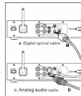
Verbinden Sie den Ausgang (Line out oder Optisch) Ihres DVD-Players / Set-Top Box / TV mit dem AUX-IN / OPTICAL IN Eingang des ICD4350. Verwenden Sie hierzu ein geeignetes Verbindungskabel.
