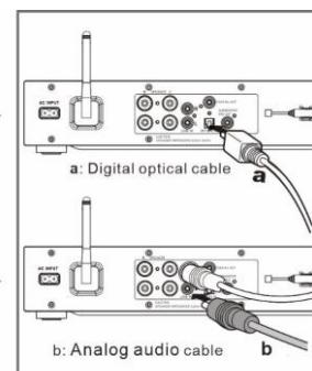
Använd en RCA-ljudkabel eller en optisk kabel för att ansluta DVD-spelarens/TV:ns utgångar till AUX-ingången eller den optiska ingången på enheten.
