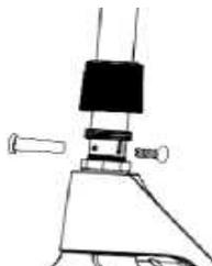
3. Sichern Sie die Schraube mit einem Schraubendreher.
