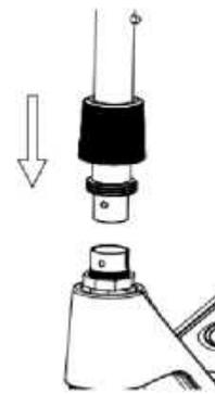
2. Verbinden Sie das vertikale Rohr mit der Bodenplatte und richten Sie es mit der Schraube aus.
