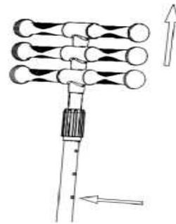
2. Halten Sie die Metallverriegelung am Lenker gedrückt, während Sie ihn nach oben ziehen oder nach unten drücken, bis der Lenker die gewünschte Höhe erreicht hat.
