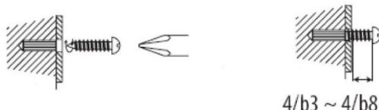
Verwijder de basis van het apparaat door de twee vergrendelingen aan de onderkant van de basis weg te trekken van het apparaat. Duw de standaardvoet naar achteren en trek hem eraf. Nu kunt u uw apparaat ophangen zoals op de afbeelding wordt getoond
