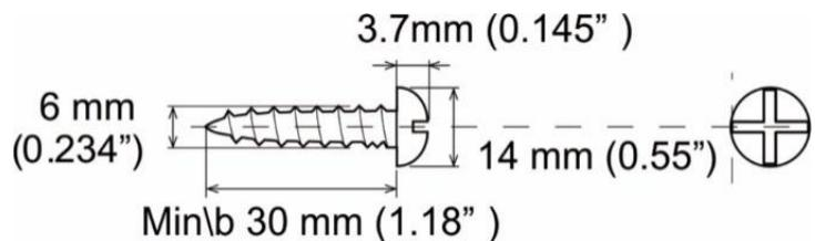
Utilisez un morceau de papier comme gabarit de perçage (non inclus) et marquez les trous à environ 160 mm d'intervalle. Fixez ensuite le gabarit de perçage au mur en position horizontale. (Comme illustré) et percez les deux trous.
