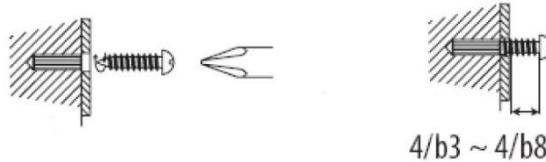
Retirez la base de l'appareil en tirant les deux verrous sur la face inférieure de la base loin de l'appareil. Repoussez le pied du support et retirez-le. Vous pouvez maintenant raccrocher votre appareil comme indiqué sur l'image
