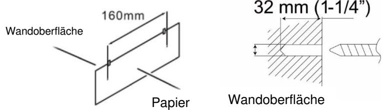
Befestigen Sie, unter Verwendung von geeigneten Dübeln, die Schrauben wie in den Bildern gezeigt
