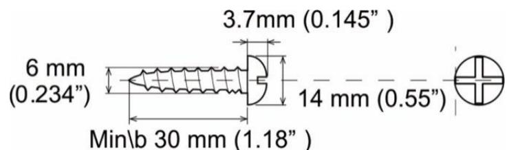
Verwenden Sie ein Stück Papier als Bohrschablone (nicht im Lieferumfang enthalten) und zeichnen Sie die Löcher in ca. 160mm Abstand an. Befestigen Sie anschließend die Bohrschablone in horizontaler Position an der Wand. (Wie abgebildet) und Bohren Sie die beiden Löcher.
