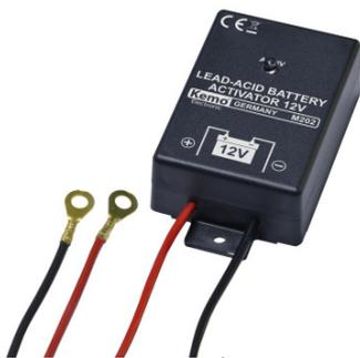
Arbeitet gegen die Ablagerung von Bleisulfat und erhöht damit die Lebensdauer des Autoakkus. Durch heftige, sehr kurze Stromimpulse wird aktiv Bleisulfat abgebaut bzw. die Ablagerung verhindert. Mit LED-Anzeige.
