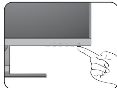
Schalten Sie den Computer an und wählen Sie eine Eingangsquelle über die OSD-Steuerungstasten aus. Die angezeigten Eingangssymbole variieren je nach verfügbaren Videoeingängen des gekauften Modells.
