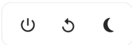
**Hinweis:** Verwenden Sie stets die Ein/Aus-Taste am Gerät oder im Einschaltmenü, um den Frameo auszuschalten. Trennen Sie nicht die Stromversorgung, wenn der Frameo in Betrieb ist.
