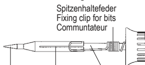
Lötspitze Soldering tip Panne Klemmschlitz Clamp slit Fente Spitzenhalterfeder Fixing clip for bits Communtateur Heizkörper Heating element Résistance
