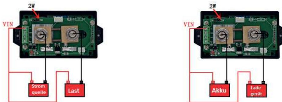
Diese Abbildungen zeigen, wie das VAX1100 für einen Messbereich von 10 bis 100 V angeschlossen wird. **Es ist zu beachten, dass der Jumper auf die Position 2W gesteckt werden muss.**
