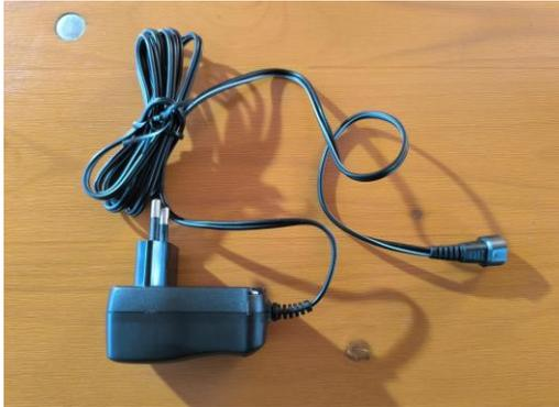
4. Netzteil Kupplung abschneiden
