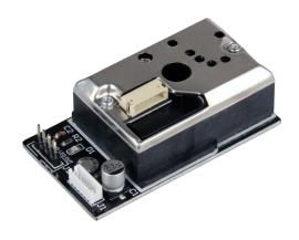
Der GP2Y1014AU ist ein optischer Sensor zur Erkennung von Staubpartikeln.
