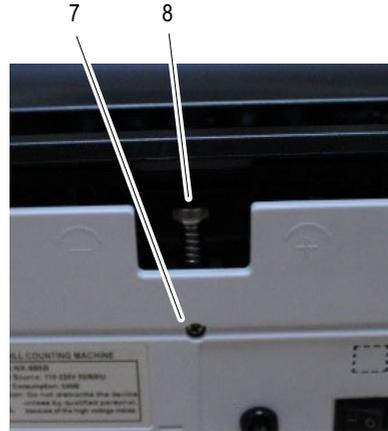
De stelschroef [8] is door middel van een borgschroef [7] geborgd tegen onbedoeld verstellen.
