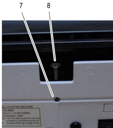
La vis de réglage [8] est dotée d'une vis de blocage [7] qui prévient tout dérèglement involontaire.
