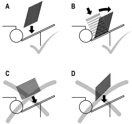
➔ Verschieben Sie die Banknoten im Banknotenbündel so, dass die obere Banknote tiefer liegt als die nächste. Legen Sie die Banknoten in das Einlegefach [4] (Abbildung A).
