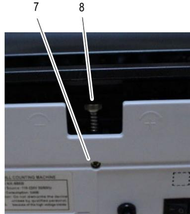
Die Einstellschraube [8] ist mit einer Sicherungsschraube [7] gegen unbeabsichtigtes Verstellen gesichert.
