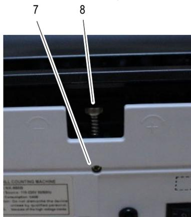
El tornillo de ajuste [8] está protegido por un tornillo de seguridad [7] contra cualquier desajuste accidental.
