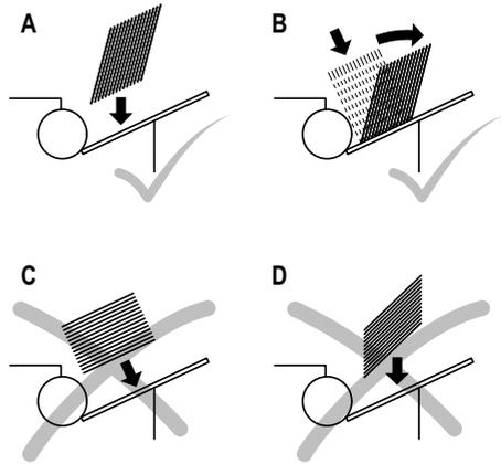
➔ Verschuif de bankbiljetten in de bundel bankbiljetten zodanig dat het bovenste bankbiljet lager ligt dan de volgende. Plaats de bankbiljetten in het inlegvak [4] (afbeelding A).
