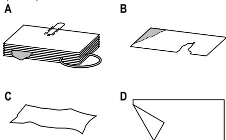
➔ Compruebe el fajo de billetes antes de introducirlo en el aparato y retire los recortes de papel, los clips, las cintas de goma y los demás objetos extraños (figura A).
