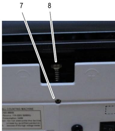
La vite di regolazione [8] è assicurata con una vite di arresto [7] contro uno spostamento involontario.
