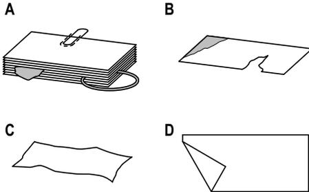
➔ Controleer de bundel bankbiljetten voordat deze erin wordt gelegd op papiersnippers, paperclips, elastiekjes en andere vreemde voorwerpen en verwijder ze (afbeelding A).
