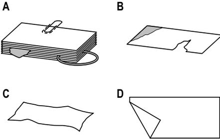
➔ Überprüfen Sie das Banknotenbündel vor dem Einlegen auf Papierschnipsel, Büroklammern, Gummibänder und andere Fremdkörper und entfernen Sie diese (Abbildung A).
