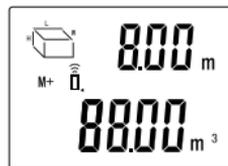
3. Drücken Sie nach Erhalt des errechneten zweiten Volumens die Taste +/- **7**, um das Volumen zum zuvor ermittelten Wert zu addieren.
