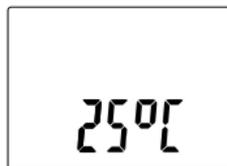
Ist das imperiale Messsystem eingestellt (ft), wird die Temperatur in °F (Fahrenheit) angezeigt. Ist das metrische System eingestellt (m), wird die Temperatur in °C (Celsius) angezeigt (siehe Kapitel „Maßeinheit ändern“).
