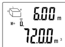
2. Drücken Sie die Taste MODUS **6**, um die momentan angezeigten Daten zu löschen. Nun können Sie die zweite Messung und Berechnung durchführen (siehe Schritte 3–5 im Kapitel „Volumenmessung“).
