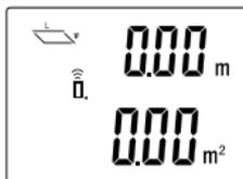
3. Das Längenzeichen (L) blinkt in der Anzeige und zeigt die erste von Ihnen ausgeführte Messung an. Drücken Sie die Taste LESEN **11**, um das Längenmaß zu erhalten, welches im oberen Bereich der Anzeige angezeigt wird.
