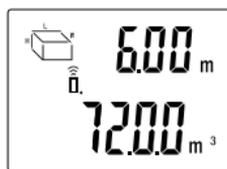
6. Drücken Sie erneut die Taste LESEN, um im oberen Bereich der Anzeige zwischen der Länge, Breite und Höhe zu wechseln.
