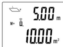
3. Drücken Sie nach Erhalt der errechneten zweiten Fläche die Taste +/- (7), um die Fläche zum zuvor ermittelten Wert zu addieren.
