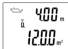
5. Drücken Sie erneut die Taste LESEN, um im oberen Bereich der Anzeige zwischen der Länge und der Breite zu wechseln.
