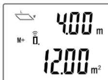
2. Drücken Sie die Taste MODUS **6**, um die aktuell angezeigten Daten zu löschen. Nun kann die zweite Messung und Berechnung durchgeführt werden (siehe Schritte 3 und 4 im Kapitel „Flächenmessung“).
