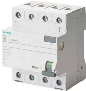
FI-Schutzschalter, 4-polig, Typ F, kurzzeitverzögert, In: 40 A, 30 mA, Un AC: 400 V
