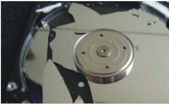
Defekter Datenträger (Geräusche beim Kippen des Laufwerks)
