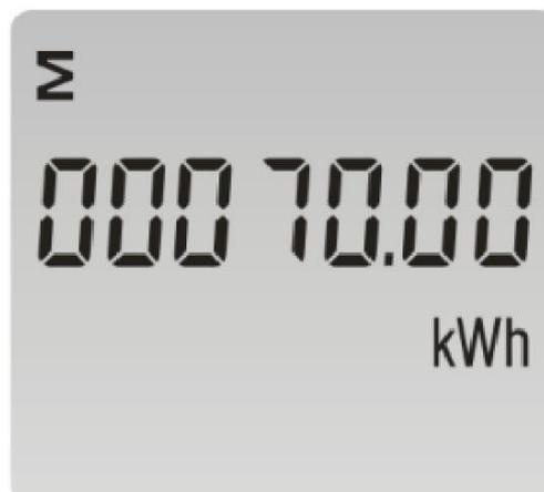
Hier wird Ihnen die kumulierte Wirkleistung Gesamt in [kWh] angezeigt.
