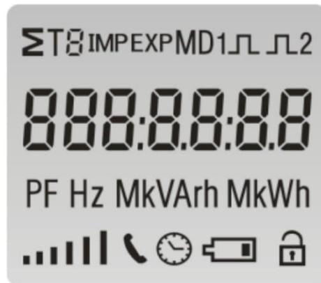
► Prüfen Sie auf dem Testbild, ob alle Elemente korrekt angezeigt werden. Nach etwa drei Sekunden werden automatisch die aktuelle Version der Firmware und die Versionsnummer der Gerätesoftware auf der Seite angezeigt, z. B.:
