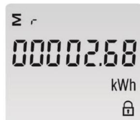
Hier wird Ihnen die resetbare Wirkleistung die Produziert wurde in [kWh] angezeigt
