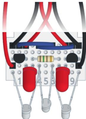
Passe den Abstand der seitlichen Sensoren an die Linienbreite an. Experimentiere mit der Neigung der Sensoren, sodass varikabi am Ende der Linie zum Stillstand kommt.
