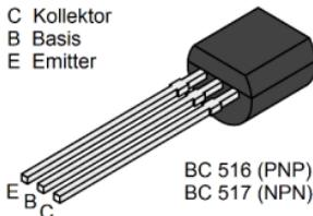
Bei einer ausreichend hohen Spannung zwischen Basis und Emmitter von etwa  $U_{BE} = 0,7 \text{ V}$  ( $V = \text{Volt}$ ), verringert ein Transistor den Widerstand zwischen Kollektor und Emmitter und er schaltet durch.
