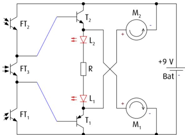
Die beiden LEDs sind mit dem Widerstand in Reihe zwischen den Transistoren angeordnet. Sie können also immer nur gemeinsam leuchten. Im Beschleunigungsmodus leuchten sie immer dann, wenn beide Transistoren voll durchschalten.
