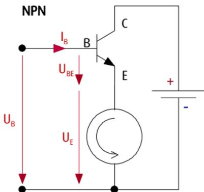
Die roten Pfeile kennzeichnen die Spannungen.
