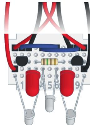
Passe den Abstand der seitlichen Sensoren an die Größe des zu verfolgenden Objektes an. Stelle den Neigungswinkel des mittleren Sensors so ein, dass er nur leicht über den Gegenstand gerichtet ist.
