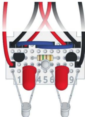
Das Umgebungslicht sollte bei dieser Funktion nicht zu stark sein, damit varikabi den Lichtschein gut erkennen kann. Experimentiere mit dem Abstand und der Neigung der seitlichen Sensoren.
