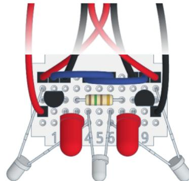
Stelle die Neigung der seitlichen Sensoren so ein, dass varikabi immer rechtzeitig am Rand wendet. Justiere den Neigungswinkel des mittleren Sensors so, dass varikabi auf hellem Untergrund stoppt.
