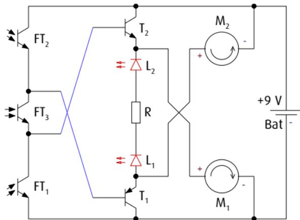
Im Bremsmodus sind die LEDs nun umgekehrt gepolt zwischen den Transistoren eingebaut. Sie können aber dennoch leuchten. Wenn nämlich beide Transistoren gesperrt sind, werden die LEDs über die stehenden Motoren mit Strom versorgt.
