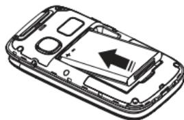
wobei zu gewährleisten ist, dass die runde Öffnung auf der Abdeckung des Akkus mit der SOS-Taste ausgerichtet ist.
