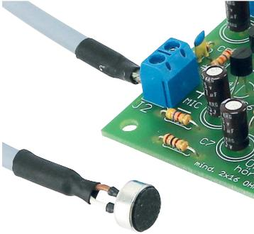
Desweiteren bietet sich als Option ein externes Poti mit 2,2 kOhm an, damit sich nach einem Einbau in ein Gehäuse die Verstärkung (GAIN) von aussen leichter einstellen lässt. Dazu muss der Trimmer TR1 ausgelötet werden. Die drei Anschlüsse von TR1 werden 1:1 mittels Litzen auf das Potentiometer gelegt.
