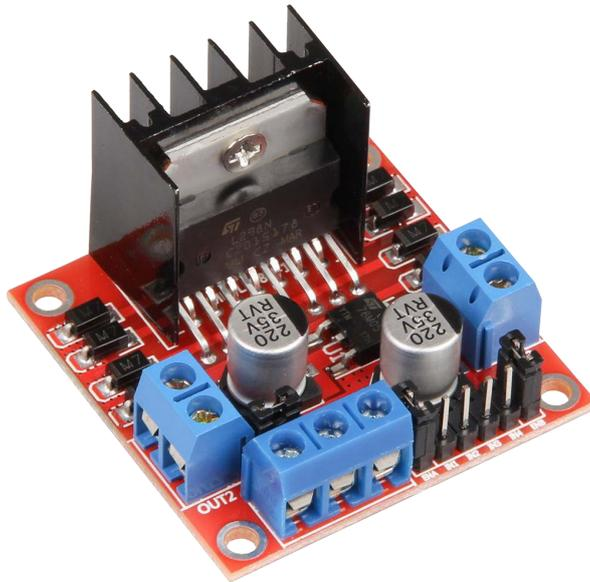
Der MotoDriver2 ist eine Erweiterungsplatine die schnell und einfach an Ihren Arduino angeschlossen werden kann und sowohl die Steuerung, als auch die Stromversorgung von zwei Gleichstrommotoren ermöglicht.
