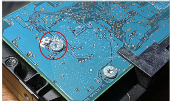
Schimmel/Rost/Korrosion auf Leiterplatte
