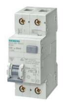
FI/LS-Schalter, 6 kA, 1P+N, Typ A, 30 mA, C-Char, In: 10 A, Un AC: 230 V
