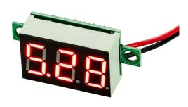
Dieses extrem kompakte Mini-Voltmessgerät für einen Spannungsbereich von 3 -30 Volt hat eine 3-Ziffern 7-Segment-Anzeige (0,36-Zoll). Der Messwert wird auf eine oder 2 Nachkommastellen genau angezeigt und alle 0,3 Sekunden aktualisiert. Der minimale Stromverbrauch von unter 30 mA zeichnet seine Leistung aus. Es verfügt über 2 Befestigungsösen.
