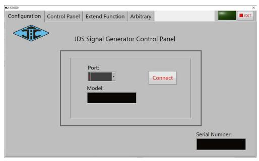
Stellen Sie anschließend die Verbindung mit **Connect** her. Im **Control Panel**, welches Sie über den Reiter im oberen Bereich der Software erreichen, können Sie die Standardwellenformen und Funktionssignale ausgeben.
