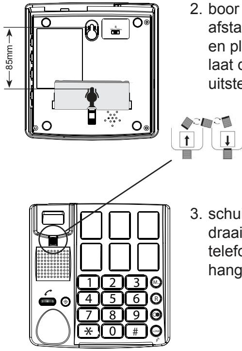
2. boor boven elkaar en met een onderlinge afstand van 8,5cm 2 gaten in de wand en plaats hierin pluggen en schroeven; laat de kop van de schroeven 5 millimeter uitsteken
