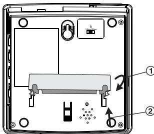
1. Montieren Sie den Wandbügel, wie auf der nebenstehenden Zeichnung beschrieben, an der Unterseite des Telefons (1) und schieben diesen nach oben (2)
