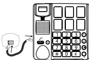
1. raccordez le cornet avec le téléphone en cliquant un bout du cordon à boucle au dessous du cornet et l'autre bout sur le côté gauche du téléphone
