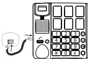
1. de hoorn met de telefoon verbinden door een zijde van het krulsnoer onder in de hoorn te klikken en de andere zijde aan de linkerzijde van de telefoon te klikken
