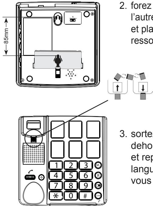
2. forez 2 trous dans le mur l'un au dessus de l'autre avec une distance mutuelle de 8.5cm et placez des chevilles et des vises ; laissez ressortir les têtes des vises de 5 millimètres
