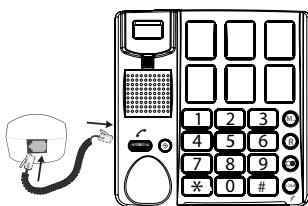
1. Verbinden Sie den Telefonhörer mit dem Telefon, in dem Sie das Spiralkabel unten in den Telefonhörer klicken und das andere Ende an der linken Seite in das Telefon klicken.
