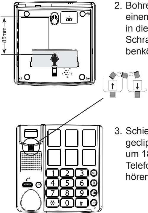
2. Bohren Sie übereinander 2 Löcher mit einem Abstand von 8,5 cm untereinander in die Wand und setzen hier Dübel und Schrauben ein; lassen Sie die Schraubeköpfe 5 Millimeter hervorstehen.
