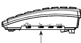
Benutzen Sie den Schalter um das Mikrofonsignal etwas abzuschwächen (Schalter nach links) oder zu verstärken (Schalter nach rechts); in der mittleren Position ist das Mikrofonvolumen neutral
