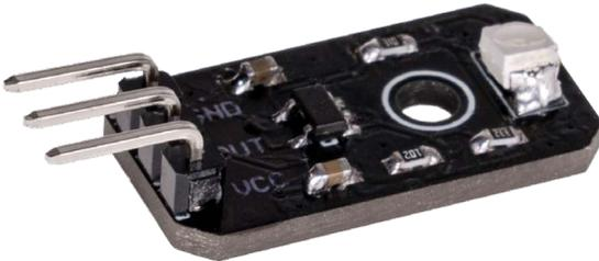
Der analoge GUVA-S12SD UV-Sensor ist eine UV-A und UV-B sensitive Fotodiode und erfasst die Intensität der auf ihn einwirkenden Ultraviolettstrahlung. Der Erfassungsbereich deckt dabei Strahlen mit einer Wellenlänge von 240 - 370 nm ab.
