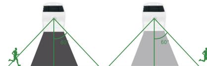
**Modus A:** Schaltet auf volle Helligkeit (220 lm), wenn im Bereich von 6 m Bewegung erfasst wird. Nach 10 Sekunden ohne weitere Bewegung wird die vordere und hintere Beleuchtung gedimmt.
