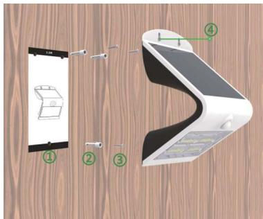
1. Nutzen Sie die beiliegende Montageschablone zum Anzeichnen der Montagelöcher.
