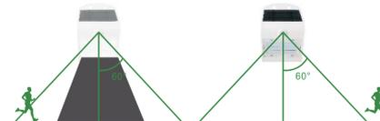
**Modus B:** Schaltet auf volle Helligkeit (220 lm), wenn im Bereich von 6 m Bewegung erfasst wird. Nach 10 Sekunden ohne weitere Bewegung wird die vordere Beleuchtung abgeschaltet und die hintere Beleuchtung gedimmt.
