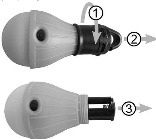
Figure 2 : retirer le porte-piles
