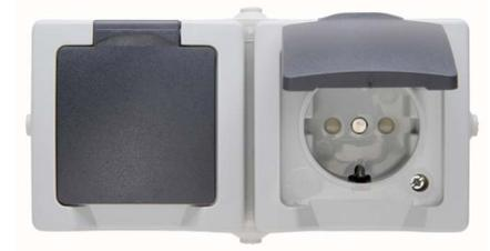
Aufputz-Feuchtraum 2-fach Schutzkontakt-Steckdose im Design NAUTIC und der Farbe grau mit Klappdeckel und erhöhtem Berührungsschutz in waagrechter Ausführung. Nennspannung beträgt 250V~ und Nennstrom 16A. Schutzart IP44.
