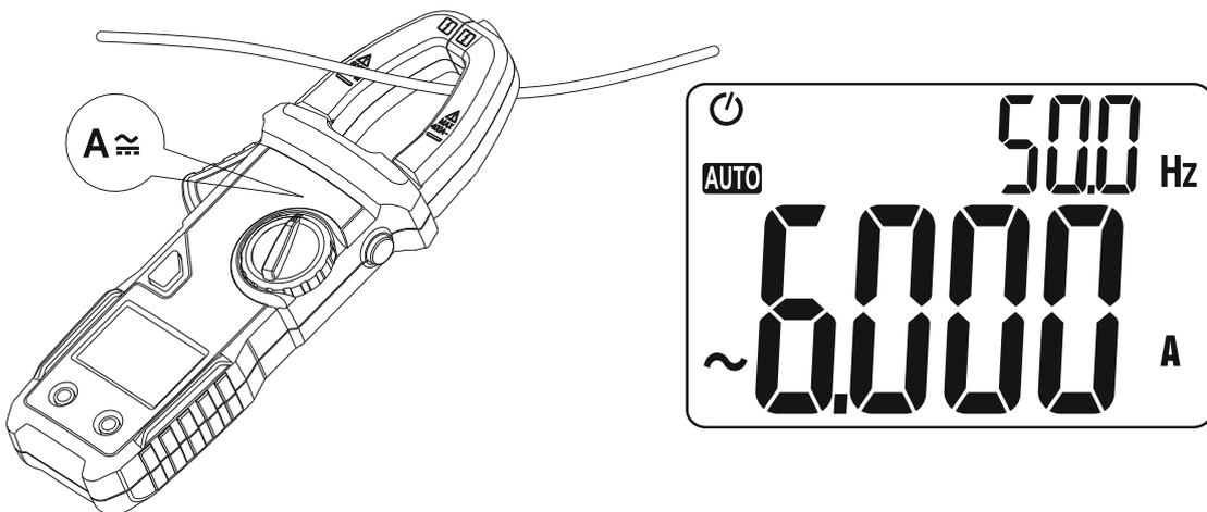
Gleichstrom: Den Wahlschalter auf  $A \approx$  stellen, mit "SEL" auf Gleichstrom-Messung schalten. Halten Sie den Abzug, öffnen Sie den Spannkopf und klemmen Sie ein Kabel des Messkreises fest. Das Haupt-LCD des Messgeräts zeigt den gemessenen Stromwert an.
