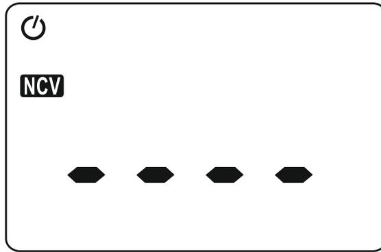
Drücken Sie den Knopf NCV, legen Sie den NCV-Sensor in die Nähe des zu messenden Kabels, das Messgerät erkennt automatisch ob die Wechselspannung des gemessenen Kabels  $> 90V$  ist. Wenn das Gerät eine Wechselspannung erkennt, fängt es an zu vibrieren und die Hintergrundbeleuchtung blinkt.
