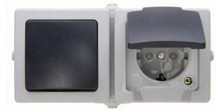
Aufputz-FeuchtraumAus-/Wechselschalter-Steckdosenkombination im Design NAUTIC und der Farbe grau in waagrechter Ausführung. Steckdose mit Nennstrom von 16A. Aus-/Wechselschalter mit einem Schaltvermögen von 10AX. Schutzart IP44
